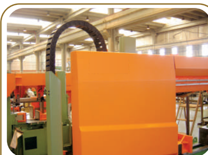
Série 370 na posição vertical em máquina de serra.
