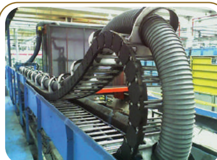
Série 660 adaptada para conduzir um tubo de 6 polegadas de diâmetro.
