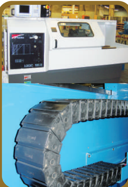
Tubo porta cabos instalado em torno automático.
