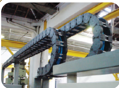
Esteira instalada em paralelo em máquina de cartonagem.
