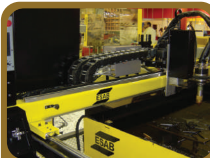
Máquina de Oxicorte - Esteiras em paralelo.
