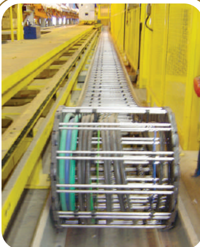
Sistema completo de esteiras porta cabos instalado em linha de solda automatizada.
