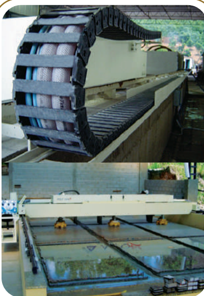
Esteira Série 370 instalada em máquina de polir granito.
